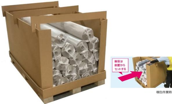
自動車シート用原反ロール(長さ 1700×直径 300mm)の包装で、従来ワンウェイ・スチールラック(内寸 2200×1110×1010 mm)に収納していたが、デッドスペースが大きくコンテナ積載効率に無駄が生じていた。また荷詰めの際、支柱で怪我の恐れがあり、安全面を最優先とした改善が求められた。そこで積載効率と作業効率向上を踏まえた改善を行った結果、外寸容積 24%削減でき、1コンテナあたりの入り数が 20%増加し、40ft コンテナの使用本数は 15%削減。ケース組立工数は 80%削減し、結果年間トータルコストが 4,680 万円削減。年間 CO<sub>2</sub> 排出は 55%(1,200トン)削減効果が得られた。
