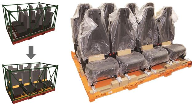
従来海外向けシート(座席)の発送荷姿には、以下の課題があった。①収容効率が悪い②スチール材のためコストが高い③固定時にシートをスライドさせ、36本のボルト締めなど、作業性が悪い。今回、軽量で設計自由度が高く、リサイクルし易い段ボールの採用により、①跳ね上げ防止構造開発、6脚→8脚入れ②コストダウン、リサイクル化③固定時のスライド作業、ボルト固定廃止、の改善を実施し効果金額▲3,000万円/年を実現した。
