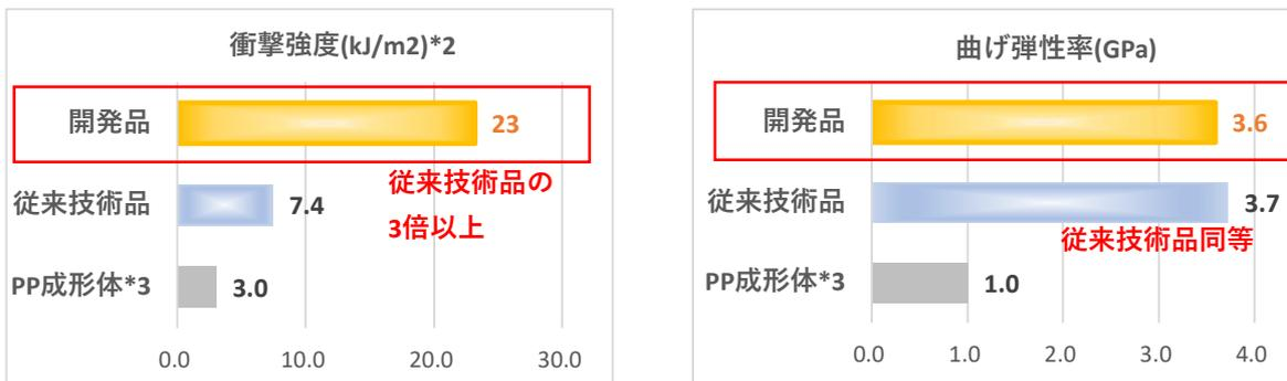
図1 セルロース複合材の耐衝撃性・曲げ弾性率
